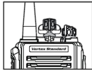
Вращайте ручку **VOL/PWR** (Громкость/Включение) для настройки уровня громкости. В отсутствие сигналов нажмите и удерживайте более одной секунды клавишу, **запрограммированную на "SQL OFF"** (шумоподавитель выключен), после этого появится фоновый шум, по которому можно будет настроить желаемый уровень громкости ручкой **VOL/PWR** (Громкость/Включение).
