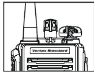
Поворачивайте расположенную в верхней части радиостанции ручку **CH** (Канал) для выбора нужного частотного канала.
