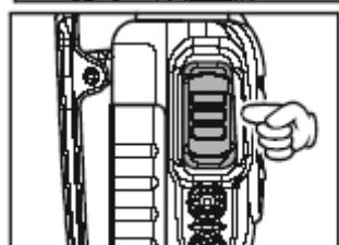
При наличии гарнитуры динамик/микрофон открутите два крепёжных винта пластиковой заглушки на правой стороне трансивера и вставьте разъём гарнитуры в гнездо **MIC/SP** (микрофон/динамик); зафиксируйте разъём входящими в комплект гарнитуры винтами. Во время приёма держите решётку динамика около уха. Для передачи нажмите клавишу **PTT** (Нажми и говори) на гарнитуре.
