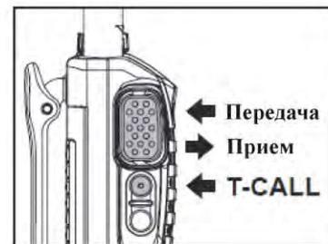
Если вы используете радиостанцию модели **B** (поставляемую в страны Европы), нажмите кнопку **T-CALL**, расположенную сразу под тангентой **РТТ**, для передачи на ретрансляторы тона частотой 1750 Гц.
