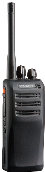
TK-D200(G)/D300(G) Модель без клавиатуры и дисплея
